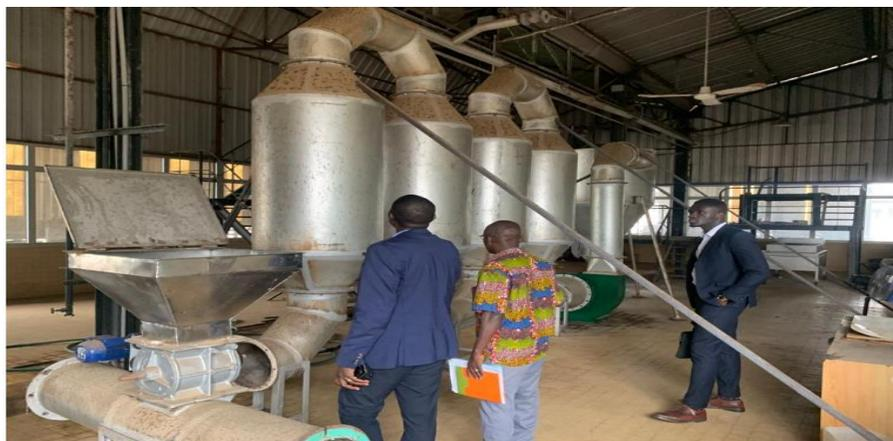
Image 2 : visite à I2T, sécheur pour la production de farine panifiable de manioc
